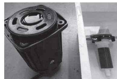
5. Zet pomphuis rechtop en vul deze met een milde ontkalker (zoals schoonmaakazijn). Leg de rotor in een plastic kom/bakje gevuld met hetzelfde anti-kalk middel en laat beiden 24 uur staan. Na 24 uur afspelen met water en pomp weer assembleren.
