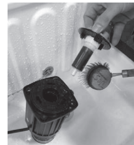
4. Laufrad vom Pumpengehäuse entfernen und mit Wasser und Bürste reinigen
